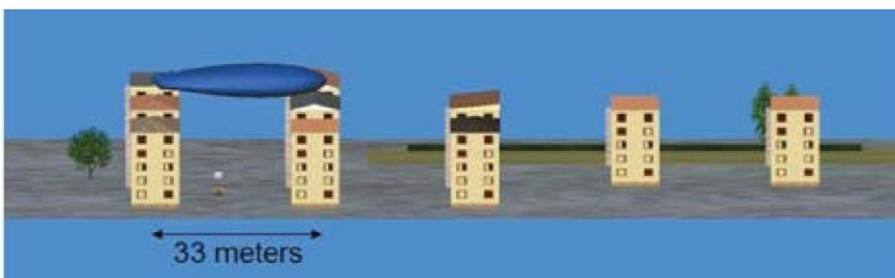
**Figura 5.** A distância de conformidade de uma estação rádiobase típica montada em um telhado, calculada para o limite de exposição de 0.6 V/m, alcança 165 metros na direção frontal.<sup>5</sup>
