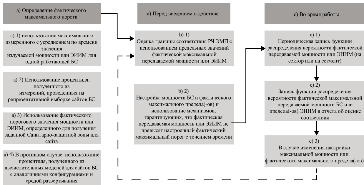
Рис. 13: Блок- схема оценки соответствия установки объекта для сайта или сектора базовой станции с использованием подхода на основе фактических максимальных значений.
