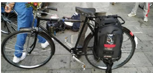
该设备集成了 5G 通讯模组、HEVC 编码器、电源, 适合广电媒体外场采访的单兵级便携式采访。前端摄像机采集的 4K 原始视频源接入 5G 背包, 经过背包内置的 4K HEVC 编码器编码后, 采用 CBT 多链路聚合传输技术, 经运营商 5G 网络上传, 后端通过 VPDN 专线在服务器接收管理软件进行视频解码、预览、转发等处理, 再输出至直播平台播出。与 H.264 相比, HEVC 编码在同等画质下码率可节省 50% 带宽, 高效的压缩可以让后续传输过程中同样的带宽传输更多的数据。5G 背包还支持低延时模式, 在 2019 年总台国庆 70 周年阅兵庆典活动 5G+4K 直播中得到成功应用。与此同时, 中国联通还与总台携手共同完成了《中央广播电视台总台 5G 媒体应用白皮书》, 该白皮书提出了 5G 网络环境下媒体制播业务应用新形态, 提出了采集传输、移动云制作、VR 制作及分发等关键环节的业务和技术标准, 为 5G 与媒体生产的深度结合和快速发展打下坚实的基础。
