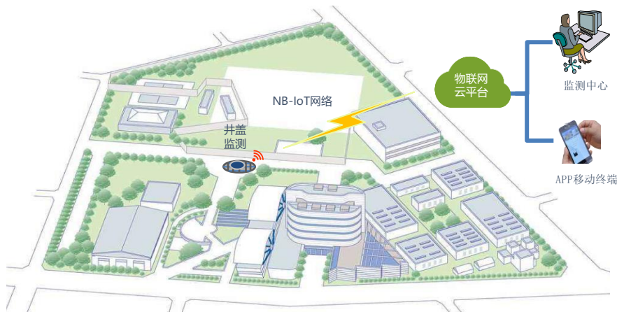
海尔工业园智能井盖监测
