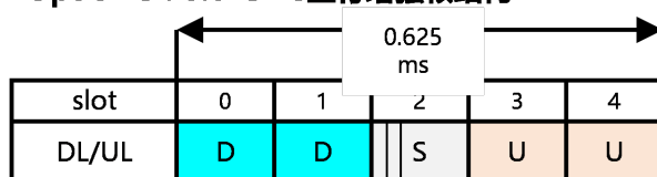
图 8 5G 毫米波灵活帧结构满足不同业务的差异化需求
