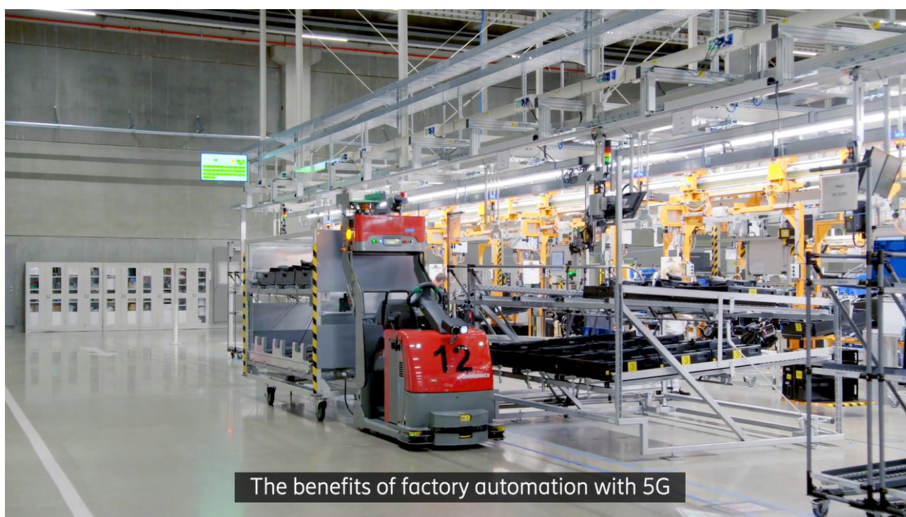
图 17 5G 毫米波支持 AGV 运行
