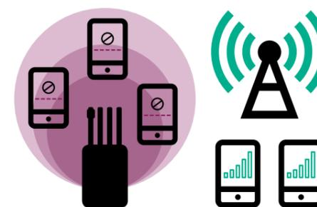
Los inhibidores actúan emitiendo una señal que interfiere la comunicación entre el móvil y las antenas
